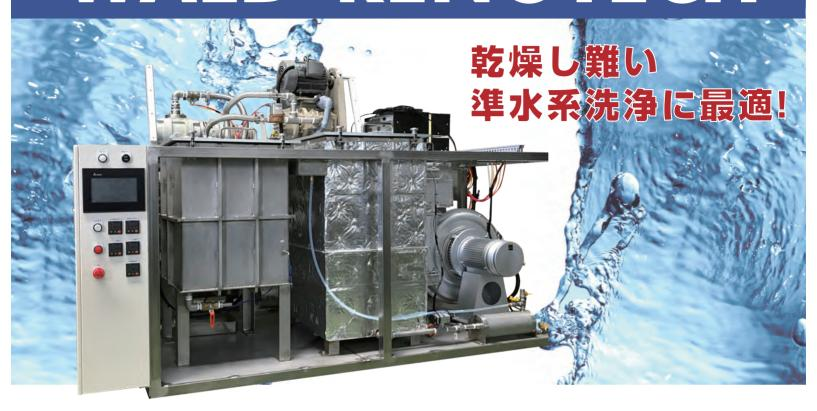
本装置「2槽式真空超音波洗浄乾燥機」は、洗浄物を入れたバスケットを人手により、 1 槽目で真空超音波洗浄、2 槽目で真空吸引液切り乾燥の工程を処理することができる洗浄装置です。
